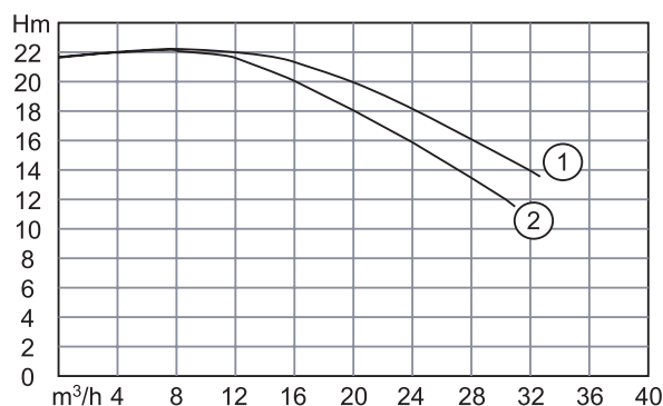
Рисунок 12 - Рабочая характеристика насоса модели EUWA/EUWY 030-040
