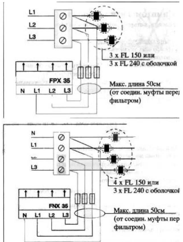
**Внимание!** В установках с предохранителями больше 63А, установку следует заранее измерять. Это для того, чтобы определить возможную потребность в дополнительном усилении и/или компенсации за реактивную нагрузку. Проси связаться с компанией АО НОБЕ ЭЛЕКТРО для консультаций и советов!
