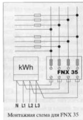
Для установки в домах предпочтительно смонтировать основной фильтр FPX 35/ FNХ 35 между счетчиком и распределителем, т.е. на шлейфе счетчика.
