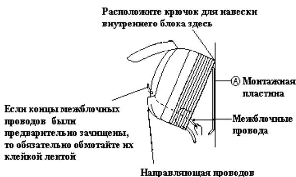
6) Нажмите обеими руками на нижнюю часть внутреннего блока, чтобы посадить его на крючки, расположенные на монтажной пластине. Убедитесь, что провода не пережаты.
