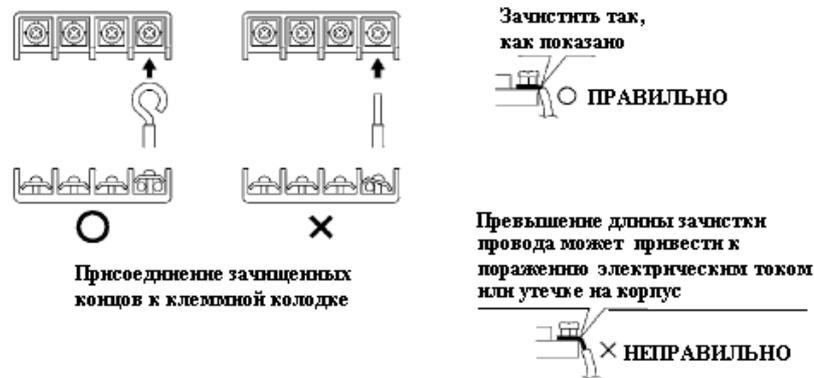
3) Потяните провода, чтобы убедиться, что они не отойдут от клеммы, а затем зафиксируйте их с помощью зажима.
