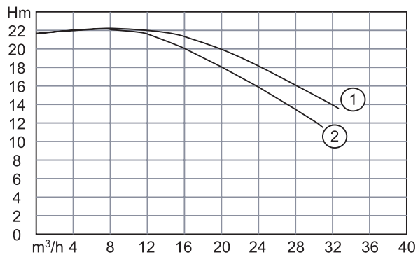
Рис. 12 - Рабочая характеристика насоса модели EUWA/EUWY 030-049
